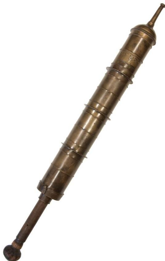
Рис. 1. Ручной насос-огнетушитель (прим. 1540 г.)
